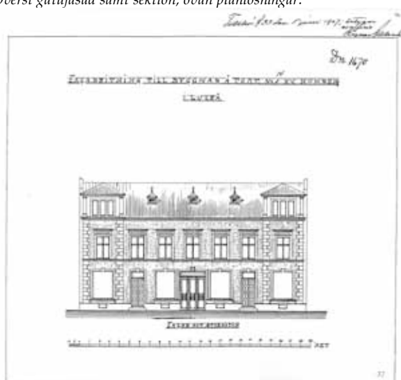
Ritning daterad 1907 som visar ny fasad i spiktegel
