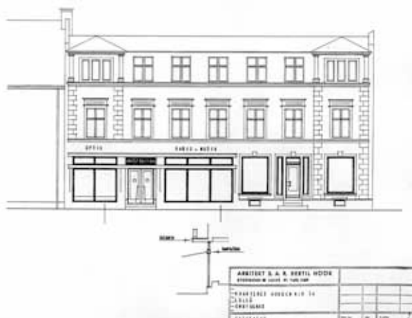
Bygglövsritning från 1956 signerad Bertil Höök. Ritningen visar ombyggnad av den västra butikens entréparti och skyltfönster.
